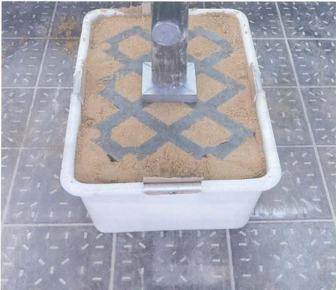
Abbildung 1: Prüfanordnung eines Kunststoffrasengittersteines auf künstlich hergestelltem Baugrund
