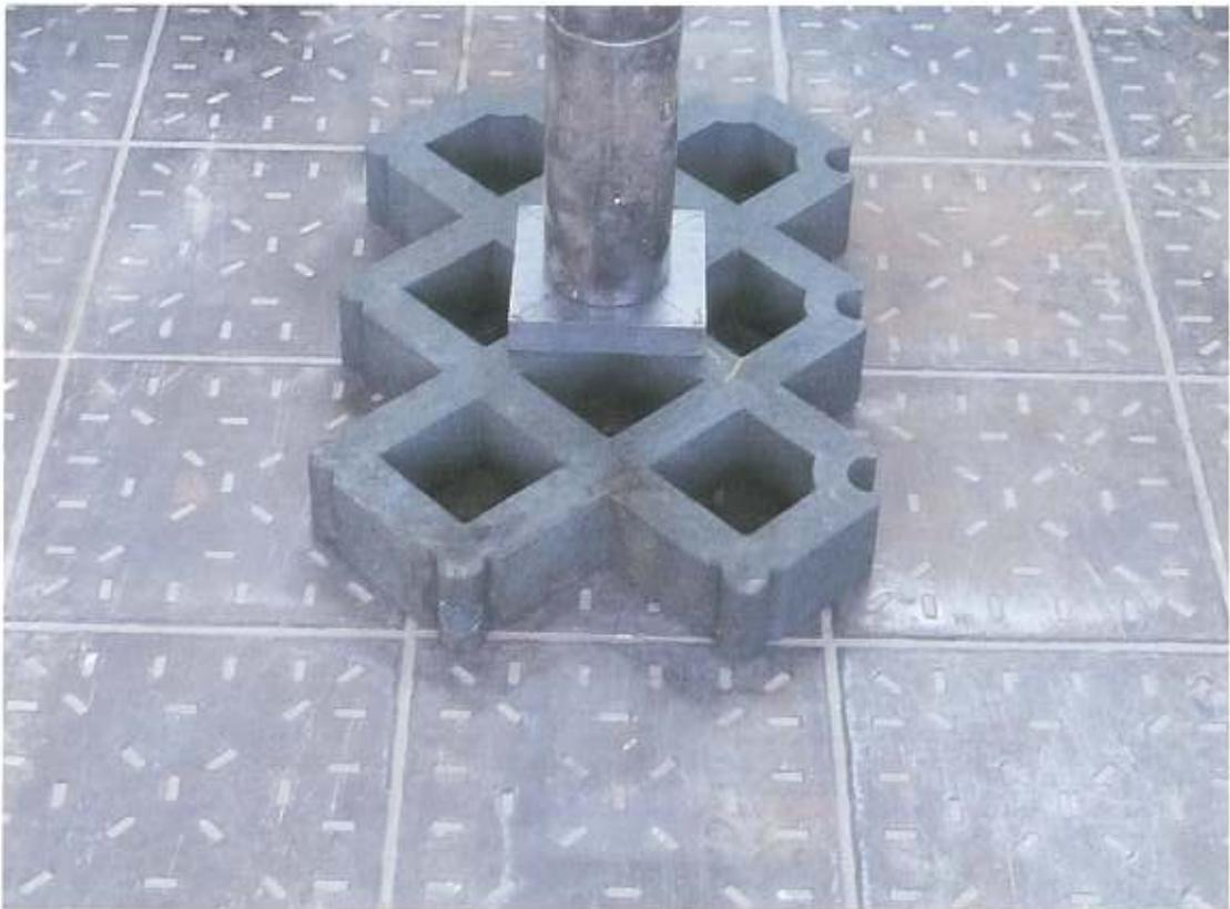
Abbildung 2: Prüfanordnung eines Kunststoffrasengittersteines auf starrem Untergrund
